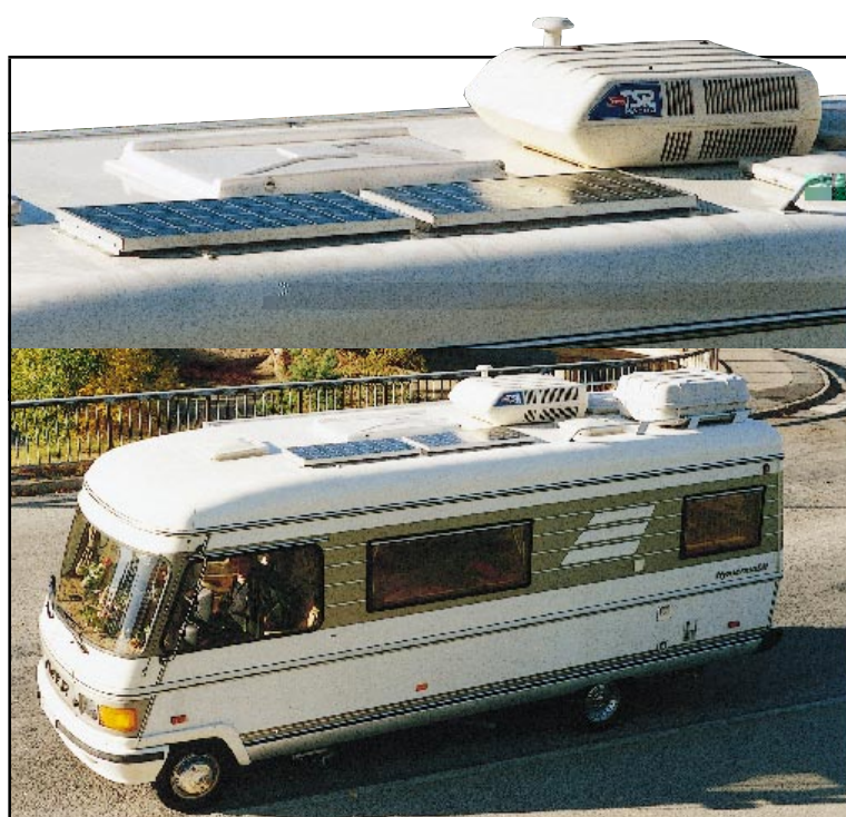
2 st 51 W solpaneler monterade på husbil.
